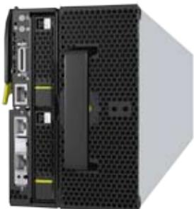
华为XH628 V3是全高双槽双路服务器节点，基于英特尔® 至强® E5-2600 v3/v4系列处理器，可最多配置12个2.5/3.5英寸硬盘和2个2.5英寸硬盘，支持华为ES3000存储加速解决方案，适合云计算、数据中心、大数据等场景对海量存储服务器的需求，帮助客户提高效率并节省空间。
